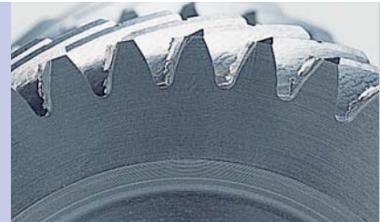
Werkstück nach dem Wälzfräsen
