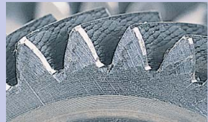
Werkstück nach dem Anfasen und Entgraten
